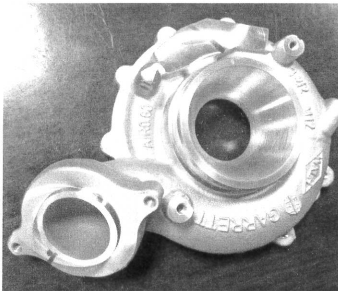
图 9 无锡蠡湖增压技术股份有限公司技术改造后生产的合格压壳铸件
